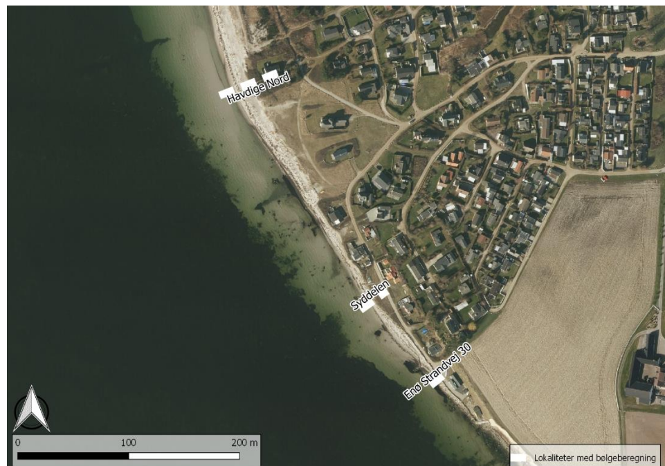
Figur 4.6: Placering af de repræsentative profiler anvendt til modellering af bølger på lavt vand samt beregning af kronekoter for havsiden af Enø og Lungshave for både dige og skråningsbeskyttelse.
