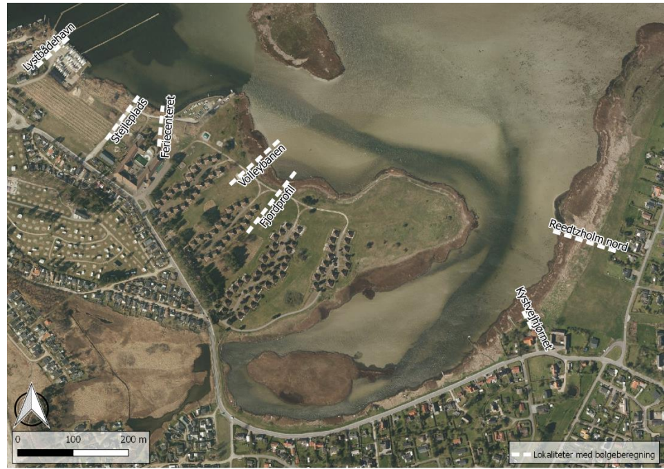
Figur 4.2: Placering af profiler anvendt til bølgetransformation og bestemmelse af digets kronekote på de strækninger af fjordsiden, hvor diget vil blive påvirket af bølger i det dimensionsgivende scenarie.
