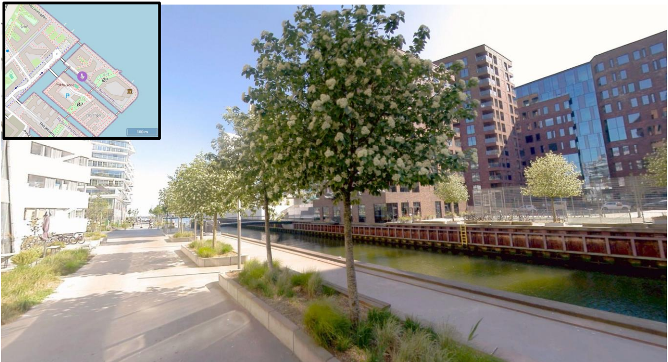
Figur 11.6: Byudviklingsområde i Aarhus Ø på tidligere havnearealer. Her er etableret kanaler med direkte forbindelse til havet og terrænet har en minimumskote svarende til den definerede sikringskote. Til venstre i billedet viser den lille markering, hvor billedet er taget fra. COWI Gadefoto.
