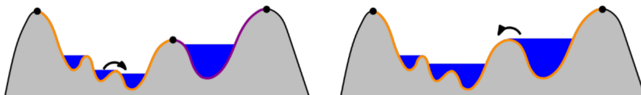
Figur 7.1: Principskitse for hvordan SCALGO Lives skybrudskort bestemmer oversvømmelser og strømningsveje. På billedet til venstre er lavningen markeret med lilla ikke helt fyldt. På billedet til højre er lavningen fyldt, og vandet strømmer nu over det laveste punkt i lavningen til lavningerne nedstrøms. Denne strømning illustreres med strømningsveje. Kilde: SCALGO Live.
